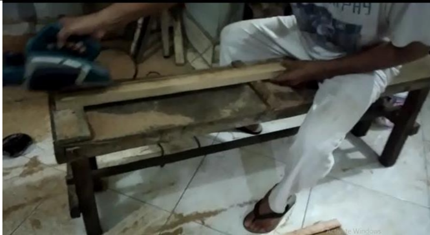
Gambar 3. Pekerjaan ketam kayu
