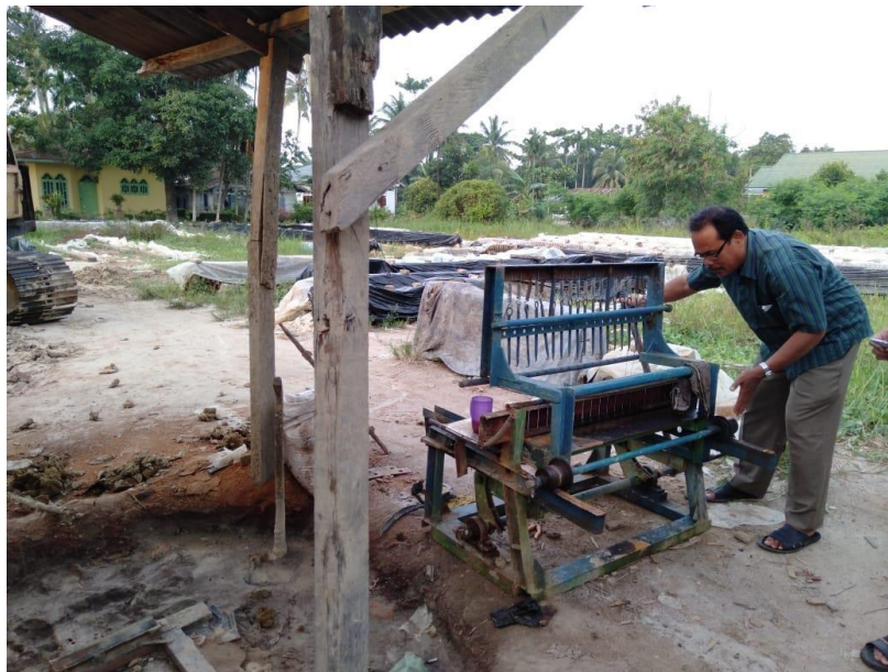
Gambar 5 Kondisi mesin cetak lama yang sudah rusak pada penahan mesin cetak di bagian rel nya
