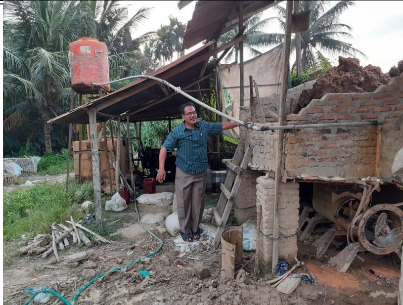
Gambar.1 Bagian pengadon campuran tanah liat menjadi batu bata
