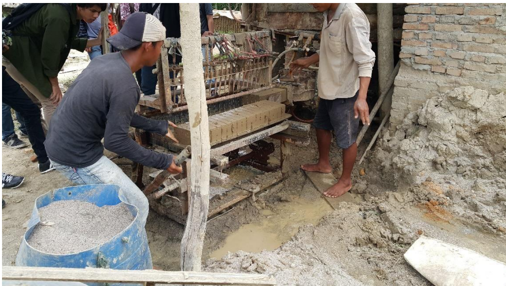
Gambar.2 Mesin Cetak batu bata lama dengan dua orang operator
