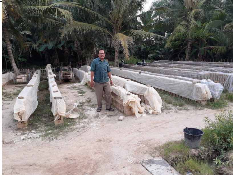
Gambar 5. Batu bata yang sudah tercetak
