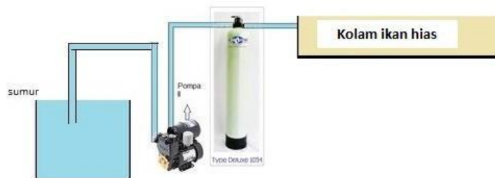
Gambar 5. Instalasi Filter air yang akan dipasang
